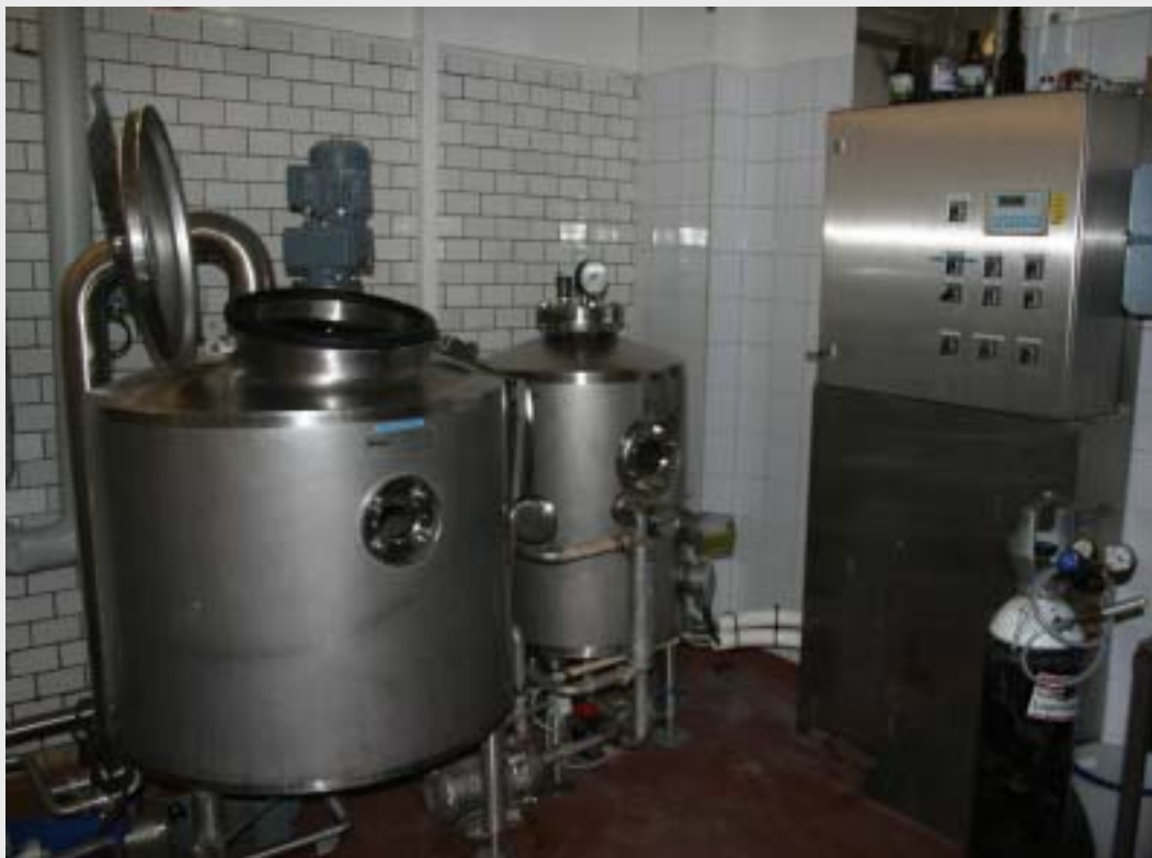
Суловарочный котел, внешний кипятитель, распред. шкаф
