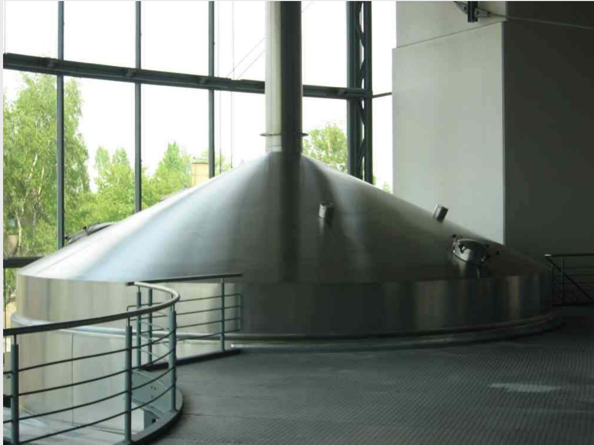
Фильтрационный чан, Ø 8 м, до 11 тонн солода
