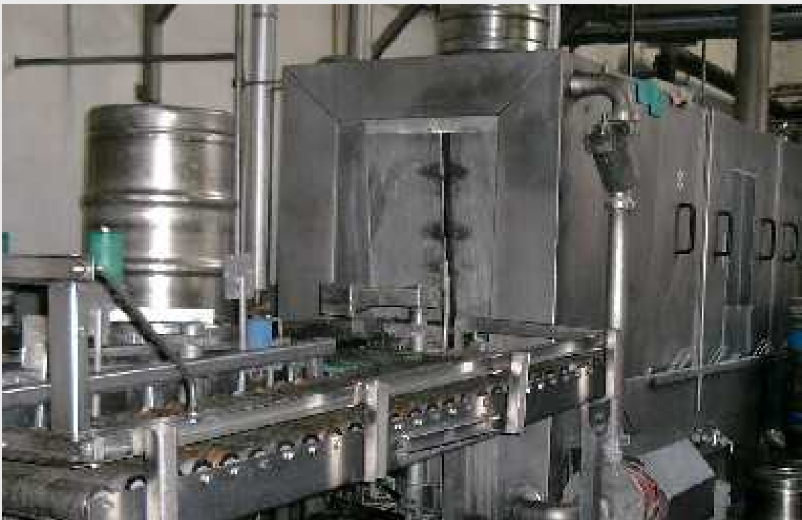
Съемщик колпачков и мойка снаружи
